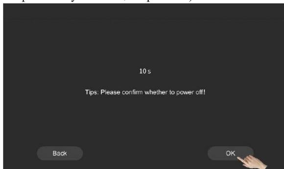
Шаг 4: Нажмите выключатель питания на задней панели устройства, чтобы полностью отключить питание кофемашины. (Предостережение: не выключайте питание напрямую, когда кофемашина включена, иначе это может привести к повреждению кофемашины).
