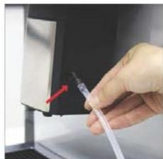
Шаг 2: Опустите подвижную часть диспенсера вниз и нажмите пальцами кнопки с обеих сторон системы вспенивания молока. Потяните на себя и снимите крышку диспенсера.
