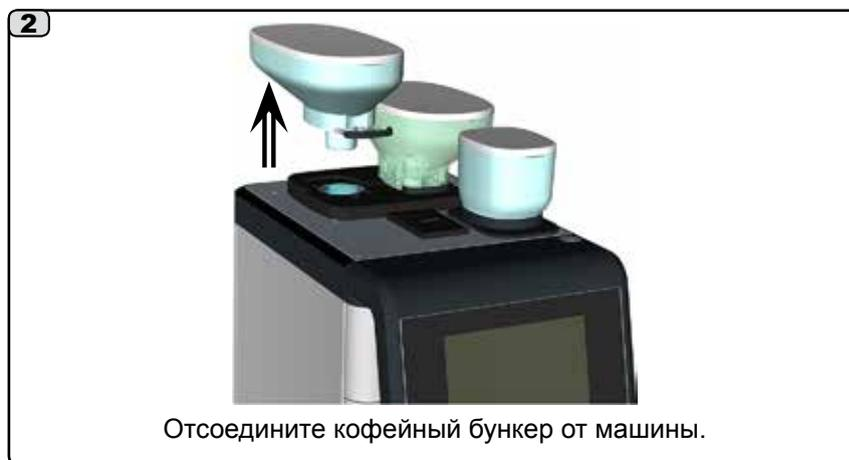
Удалите из бункера остатки кофе. Протрите влажной тканью с использованием средств и методов, обычно применяемых для изделий, контактирующих с пищевыми продуктами. Тщательно ополосните и высушите, удалив все органические отложения. Перед установкой бункера на кофемолку/дозатор убедитесь, что мокрые или влажные детали полностью высохли.
