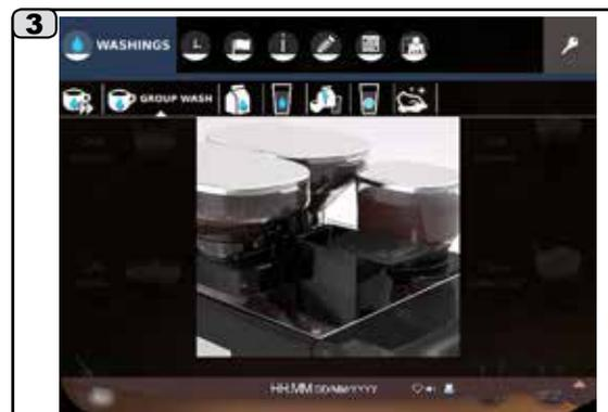
Положите таблетку моющего средства в трубку отсека для декофеинизированного кофе в соответствии с инструкцией на сенсорном экране.
