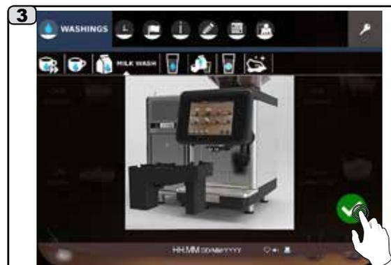
Порядок промывки молочного контура отображается на сенсорном экране, в конце каждого этапа нажимайте на значок
